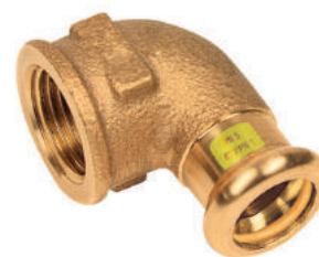
Kniekoppeling 90° lange binnendraad x press (m-profiel)
